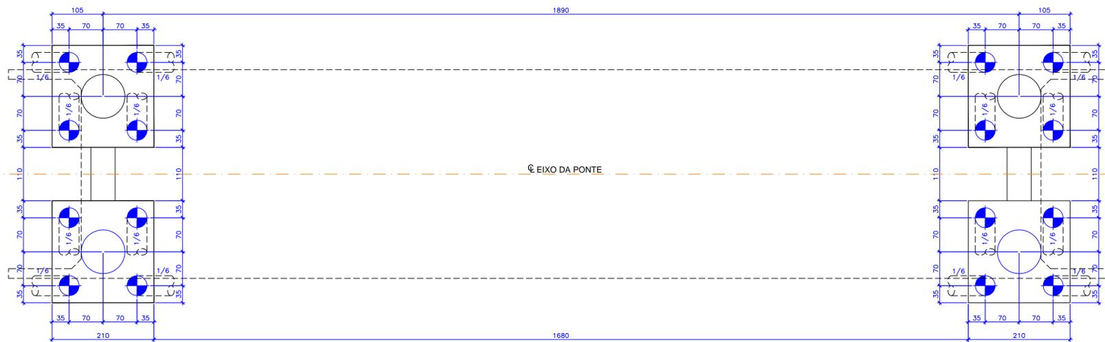
5 PLANTA DE LOCAÇÃO DOS BLOCOS E ESTACAS
